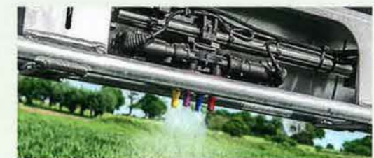
Vier Düsen werden bei „OptiNozzle“ automatisch geschaltet.
