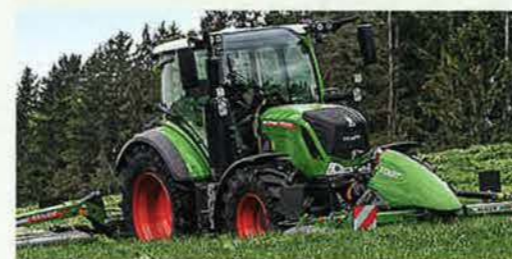
Bis zu 10 PS Boost schaltet das System beim Fendt 314 frei.
