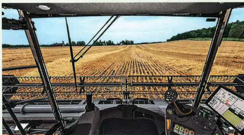
Statt per Lenkrad kann der Ideal optional per Joystick auf der linken Armlehne gesteuert werden – auch im Straßenverkehr bei 40 km/h!
